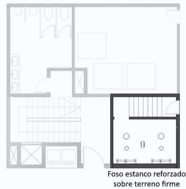
Núcleo en subsuelo (-1.5m enterrado)
