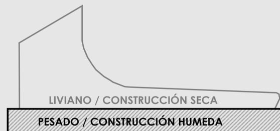
El conjunto edilicio maneja una lógica de "liviano" arriba en lo que es la construcción en madera laminar, seca; y "pesado" en las plataformas y subsuelos.
